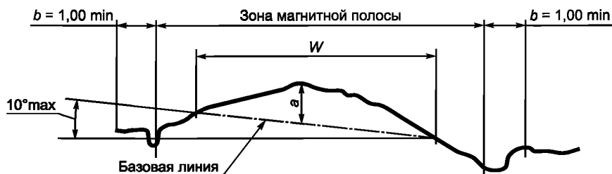
Рисунок 7 — Выпуклый профиль полосы
