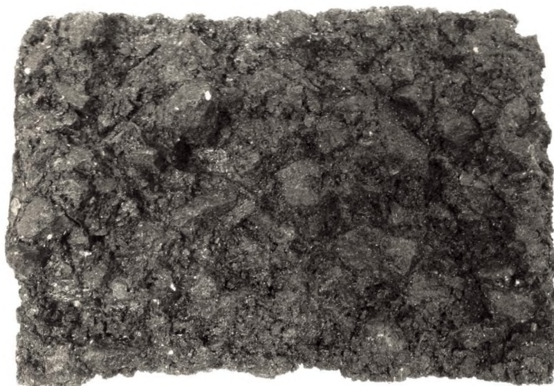
Рисунок А.8 – Поверхность разлома асфальтобетонного образца
