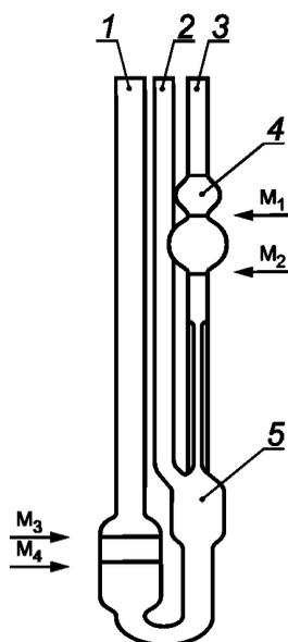
Рисунок Б.4 — Вискозиметр типов ВПЖТ-1, ВПЖ-1 (BS/IP/SL)
