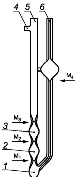
1 — резервуар; 2 — резервуар, по времени заполнения которого вычисляют вязкость; 3 — резервуар для контроля;
