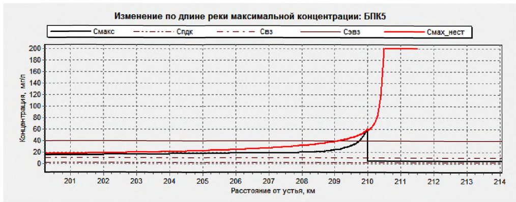
Рисунок В.7 – Вид отчетных материалов по результатам моделирования влияния распределенного нестационарного сброса сточных вод (страница 1)
