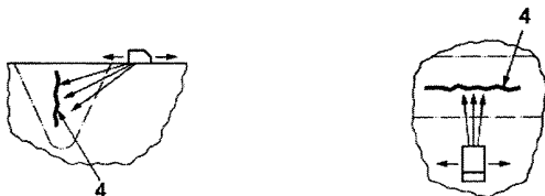
б) типичный случай при прохождении ультразвукового луча по толщине
