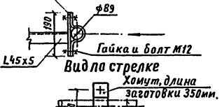
Деталь поз. 14 Ст. полосовая 60x2
