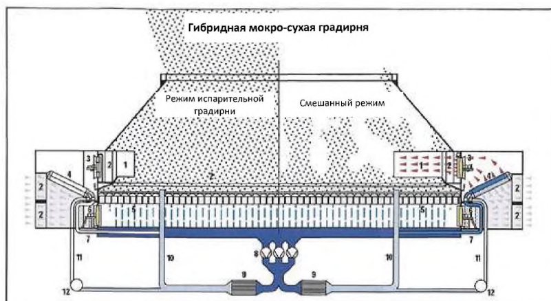
Рисунок 7.3 — Принципиальная схема открытой гибридной градирни (пример применения в электроэнергетике):
