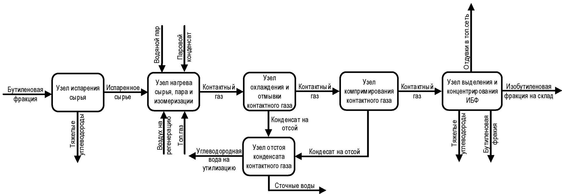
Рисунок 2.3.2 – Блок-схема процесса изомеризации нормальных бутенов в изобутилен
