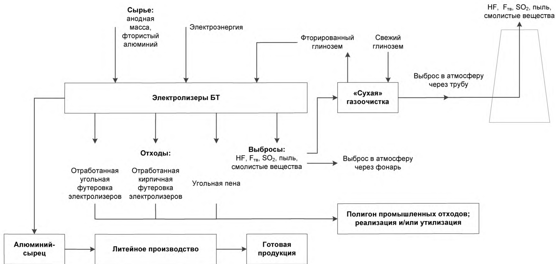
Рисунок 2.6 — Блок-схема производства первичного алюминия в электролизерах с боковым токоподводом
