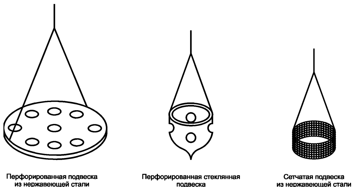
Рисунок 1 — Примеры подставок под испытуемый образец
