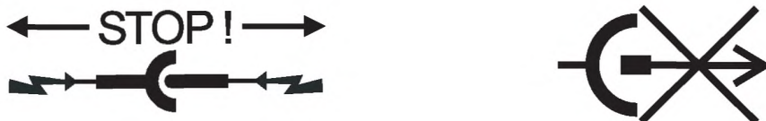
Рисунок А.1 — Примеры знака «Под напряжением! Не разъединять»
