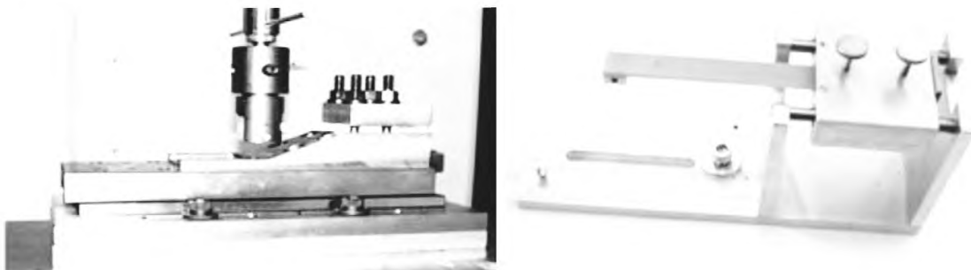
Рисунок 3 — Варианты исполнения приспособлений для испытаний на торцевое расслоение
