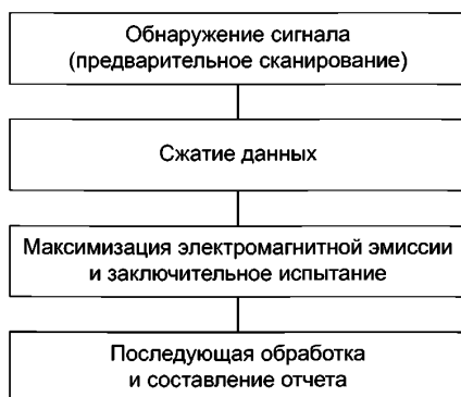
Рисунок 19 — Процесс, обеспечивающий уменьшение времени измерения
