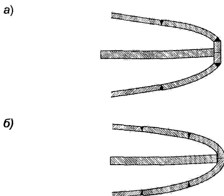
Рис. 3.10.2.6.2-1 Примеры комбинированного (а) и листового (б) форштевней
