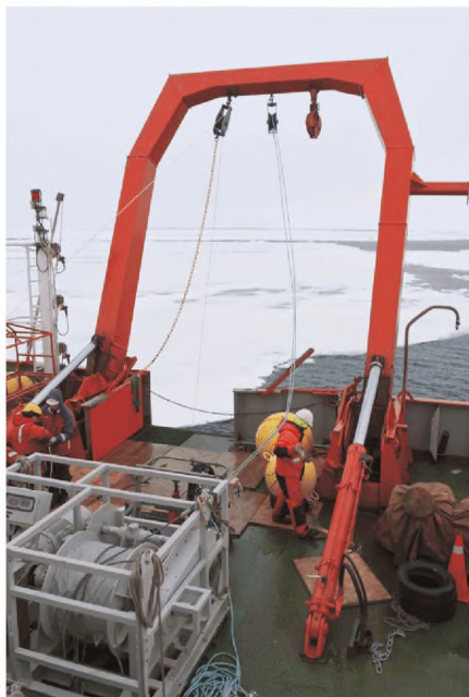
Рис. 17.16 Внешний вид шпиля, лебедки и П-образной рамы с закрепленными блок-шкивами, используемых для постановки притопленных буйковых станций
