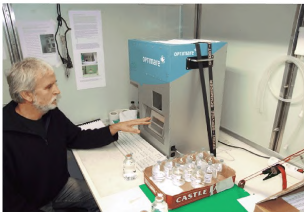
Рис.6.4 Пример интерьера термостабилизированной лаборатории на немецком RV Polarstern. Показан высокоточный калибровочный солемер и работающий с ним оператор. На стенах видны полозья для закрепления коушей на любой высоте. За эти коуши можно закреплять широкий спектр измерительных лабораторных устройств, нуждающихся в стабильной температуре. Площадь лаборатории на фотографии 10 м 2 .
