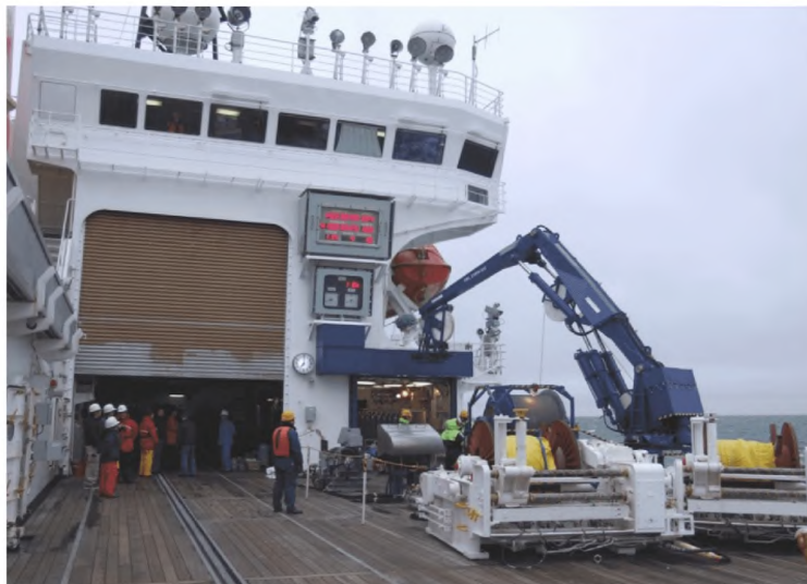
Рис.6.1 Вид от кормы на выходы на рабочую палубу японского НИС Mirai. Слева большие сдвижные вверх ворота большой мокрой лаборатории-ангара. Справа – выход из той части мокрой лаборатории, где располагается наиболее часто выводимый в экспедициях на палубу инструмент – пробоотборник воды с присоединенным СТД зондом. При всех выходах из мокрой лаборатории на рабочую палубу отсутствуют какие-либо барьеры. Сверху (над палубой) центральный пост управления лебедками.
