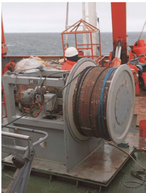
Рис. 17.16 Внешний вид шпиля, лебедки и П-образной рамы с закрепленными блок-шкивами, используемых для постановки притопленных буйковых станций
