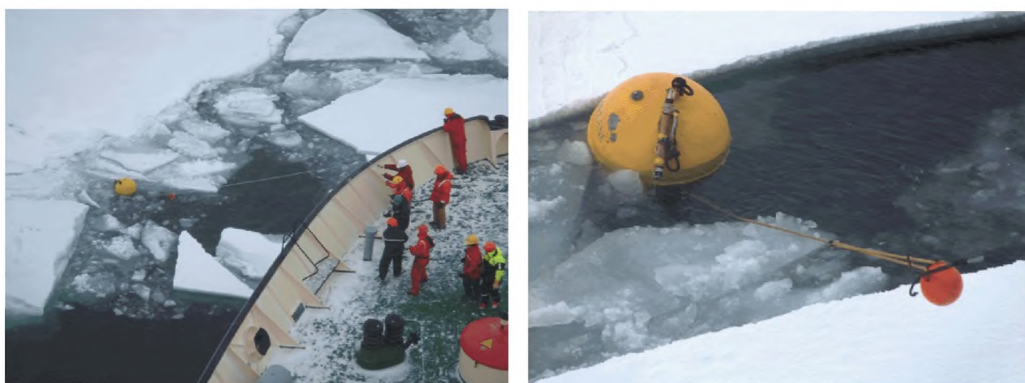
Рис. 17.11 Подъем притопленной буйковой станции в условиях высокой сплоченности льда в районе постановки ПБС.
