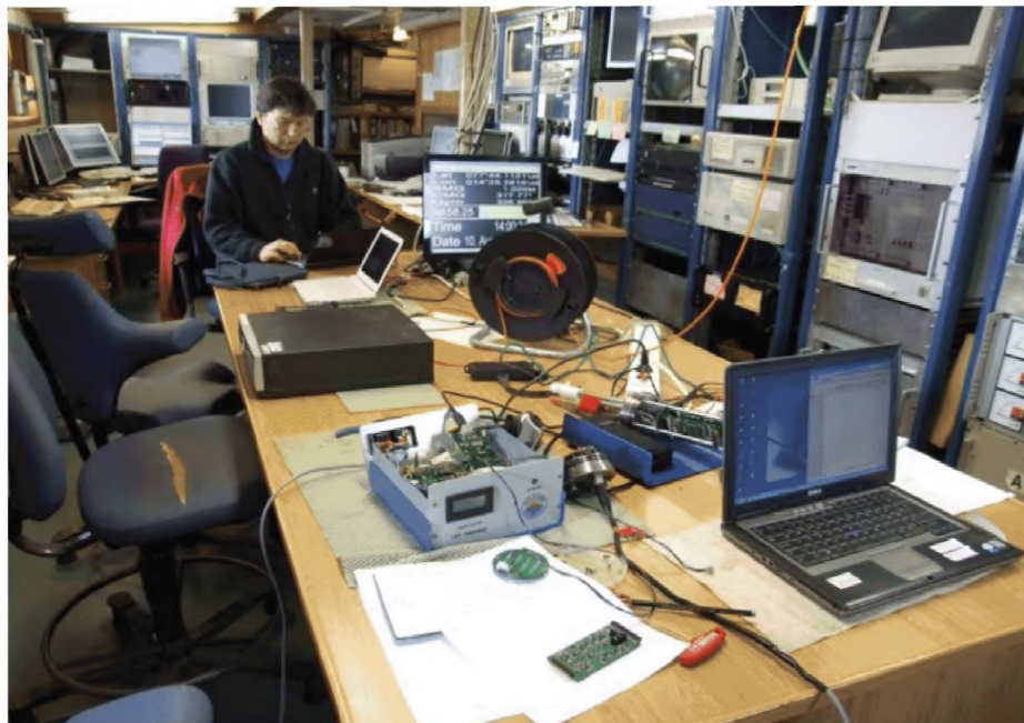
Рис. 6.7 Пример интерьера лаборатории норвежского НИС Naakon Mosby. На снимке в лаборатории производятся гидрофизические измерения. Измерители, расположенные на стеллажах (на заднем плане снимка), как правило, не демонтируются от экспедиции к экспедиции. На них выводятся показания измерений встроенного в судно измерителя течений, метеорологической станции, навигационные параметры движения судна, показатели эхолота.
