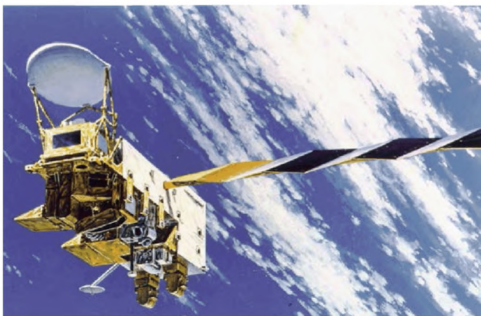
Рис. 18.1 Космический аппарат Aqua с шестью приборами для наблюдения океана, атмосферы, суши, ледового и снежного покрытия, земной растительности
