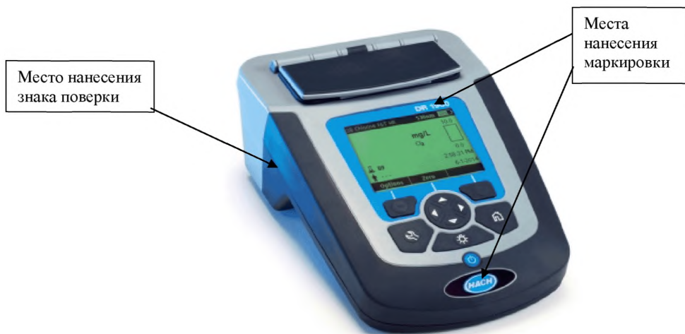
Рис.16.21 Общий вид спектрофотометра DR 1900 с обозначением мест нанесения маркировки и знака поверки
