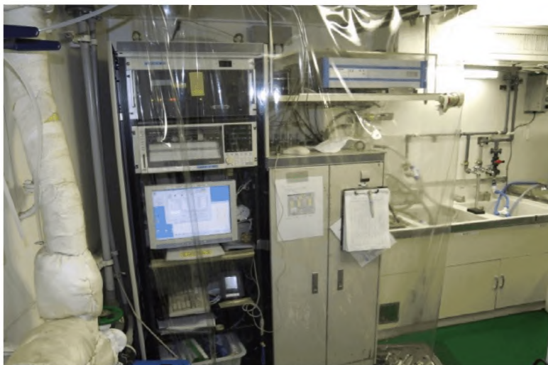
Рис. 6.5 Пример интерьера проточной лаборатории. Заборная вода поступает по стационарному крану, имеющему продолжение в виде голубого шланга. Некоторый набор проточных анализаторов установленных на стеллаже, виден в левой части снимка.
