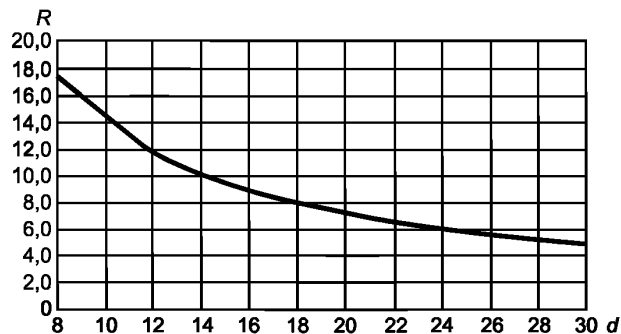
Рисунок 4 — Зависимость угла поворота от диаметра крепления
