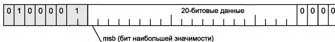
Рисунок 18 — Расположение 20-битовых данных в 24-битовом поле
