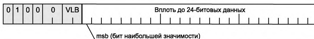
Рисунок 17 — Данные аудиосигнала формата raw
