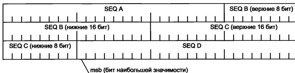
Рисунок 11 — Пакетное событие с 24-битовой последовательностью событий
