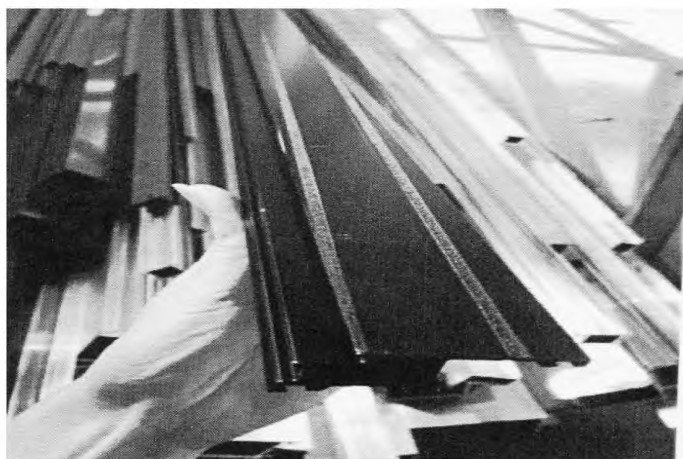
Рисунок А.55 — Следы от слипания профиля в печи полимеризации
