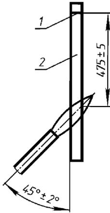
Рис. ПЗ.5-2. Приложение пламени горелки к образцу:
