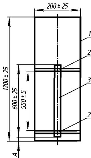
Рис. ПЗ.5-1. Расположение образца в испытательной камере:
