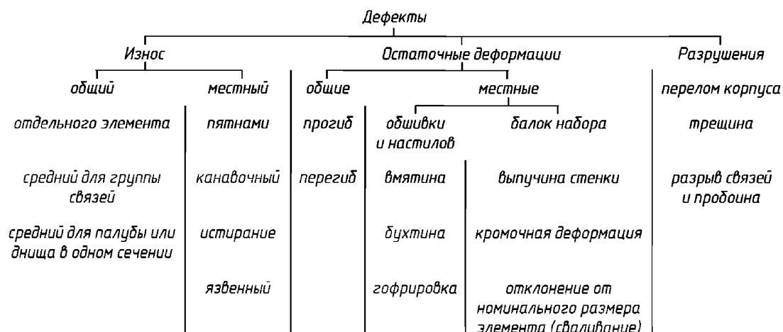
Рис. П2.2.2. Классификация дефектов корпуса судна
