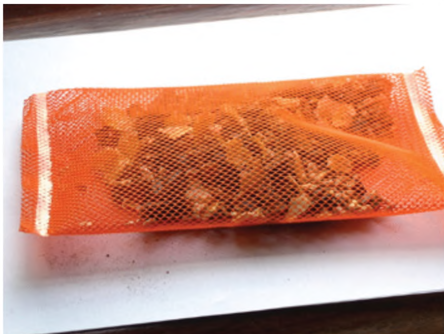
Рисунок С.9 — Пластиковая сетчатая ловушка с приманкой
