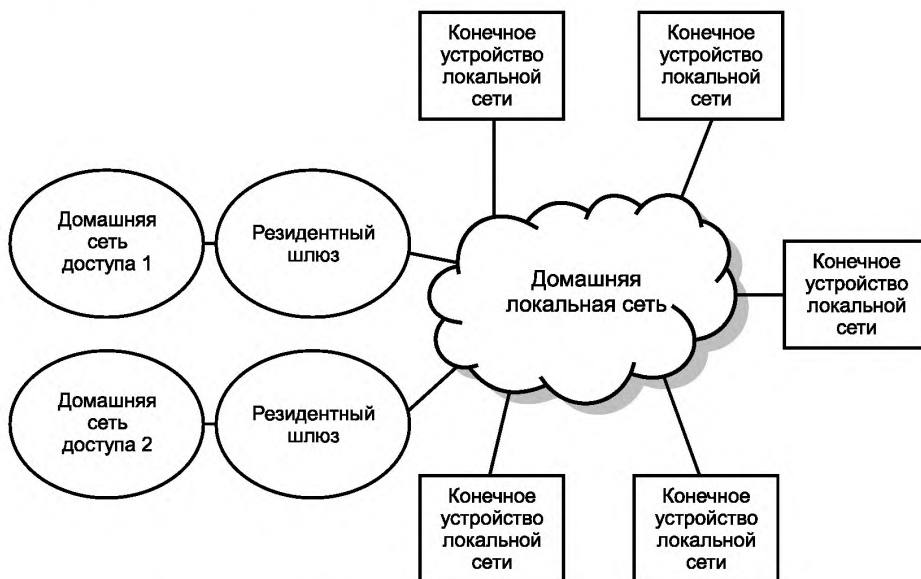
Рисунок 2 — Структурная схема модели домашней локальной сети
