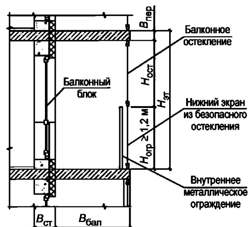
Принципиальная схема компоновки балкона (вариант с панорамным остеклением балкона)
