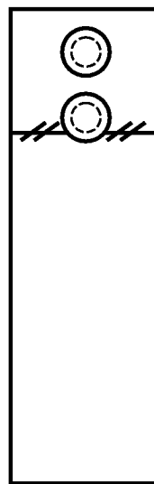
Рисунок Г.14 — Разрушение при сжатии типа LGF: поперечное разрушение по краю крепления, гайки, шайбы (обычно происходит вдоль направления армирования 0°)
