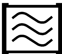
Рисунок 1 — СД лампа, предназначенная для работы на высокой частоте
