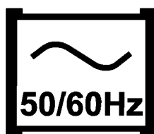
Рисунок 2 — СД лампа, предназначенная для работы на частоте 50 или 60 Гц
