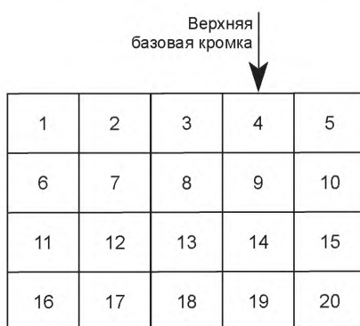
Рисунок 8 — Тестовые зоны PICC при испытании на воздействие ESD
