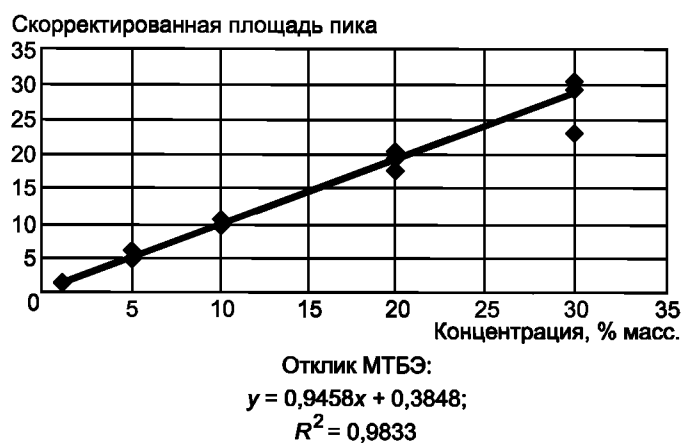
Рисунок А2.4 — Определение расчетного отклика при анализе МТБЭ методом ИНА
