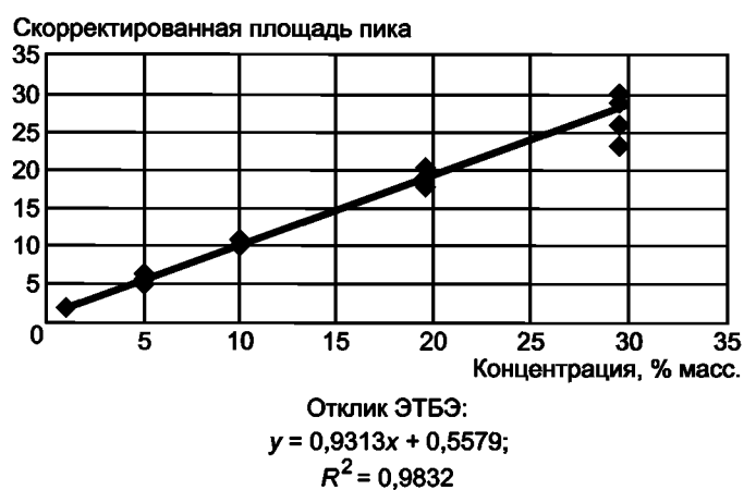
Рисунок А2.5 — Определение расчетного отклика при анализе ЭТБЭ методом ИНА
