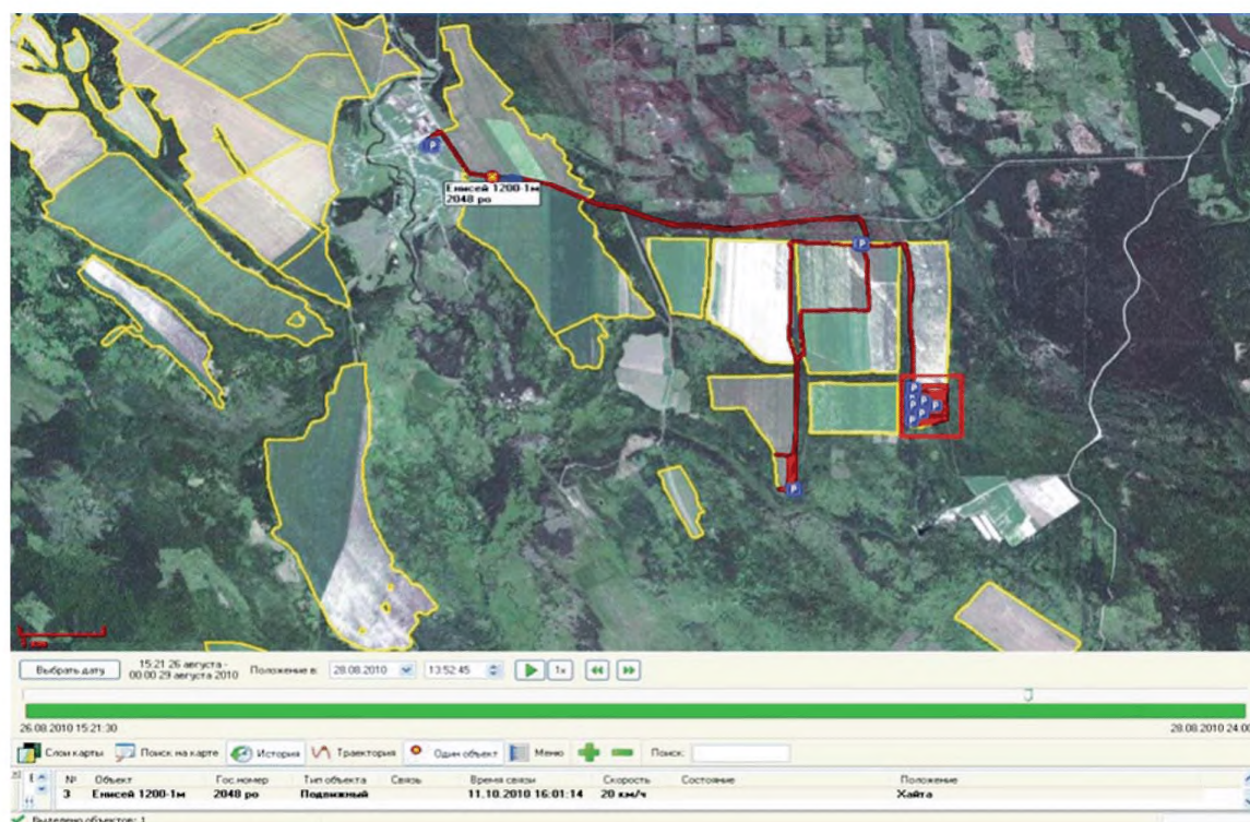
Рис. 5.3.18. Контроль выполнения работ с использованием ГЛОНАСС-технологий
