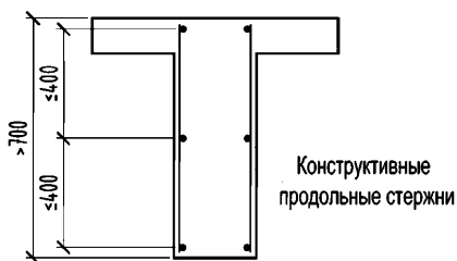
Рисунок 5.1 – Установка конструктивной продольной арматуры по высоте сечения балки
