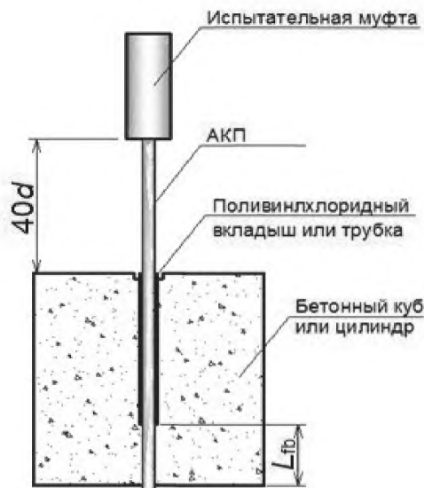
Рисунок 8.1 – Схема образца для испытаний
