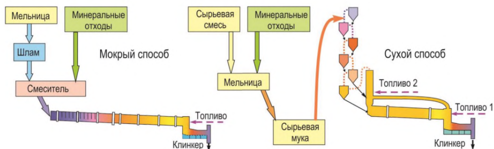
Рисунок 2.35 — Рациональные схемы применения минеральных отходов при различных способах производства клинкера
