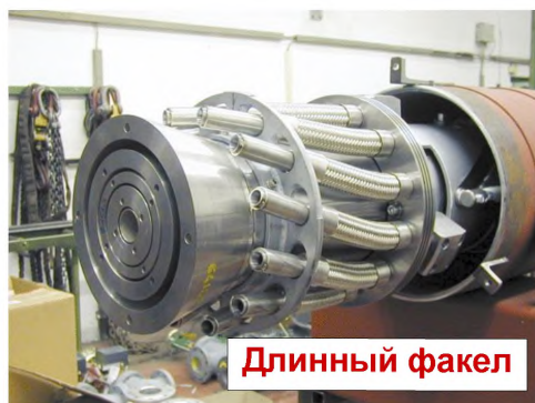
Рисунок 2.32 — Система гибких шлангов подачи первичного воздуха, обеспечивающих различную длину и форму факела
