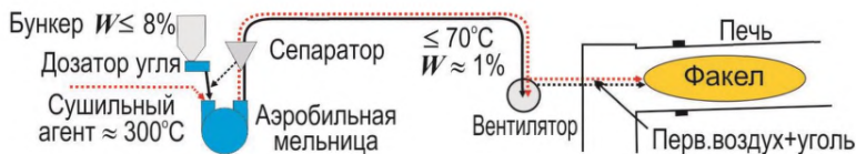
Рисунок 2.26 — Система прямого вдувания угольного порошка в печь 1)
