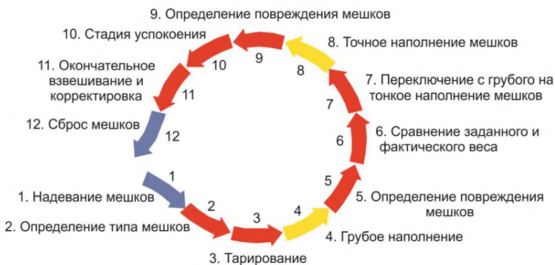
Рисунок 2.74 — Последовательность операций тарирования цемента упаковочной машиной
