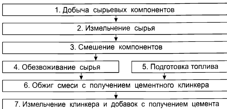
Рисунок 2.1 — Стадии производства портландцемента
