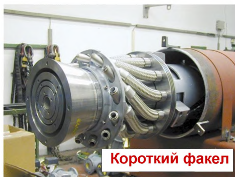
Рисунок 2.32 — Система гибких шлангов подачи первичного воздуха, обеспечивающих различную длину и форму факела
