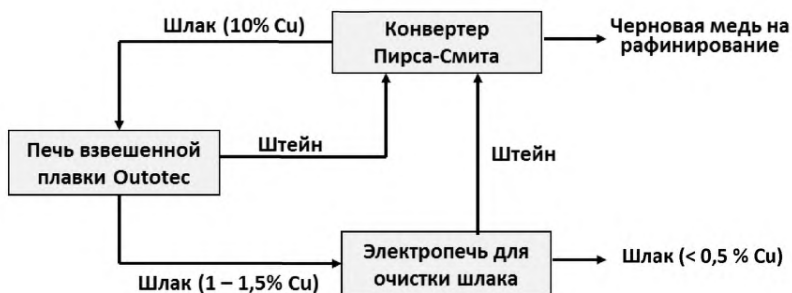
Рисунок 2.12 — Переработка медного шлака в электродуговой печи
