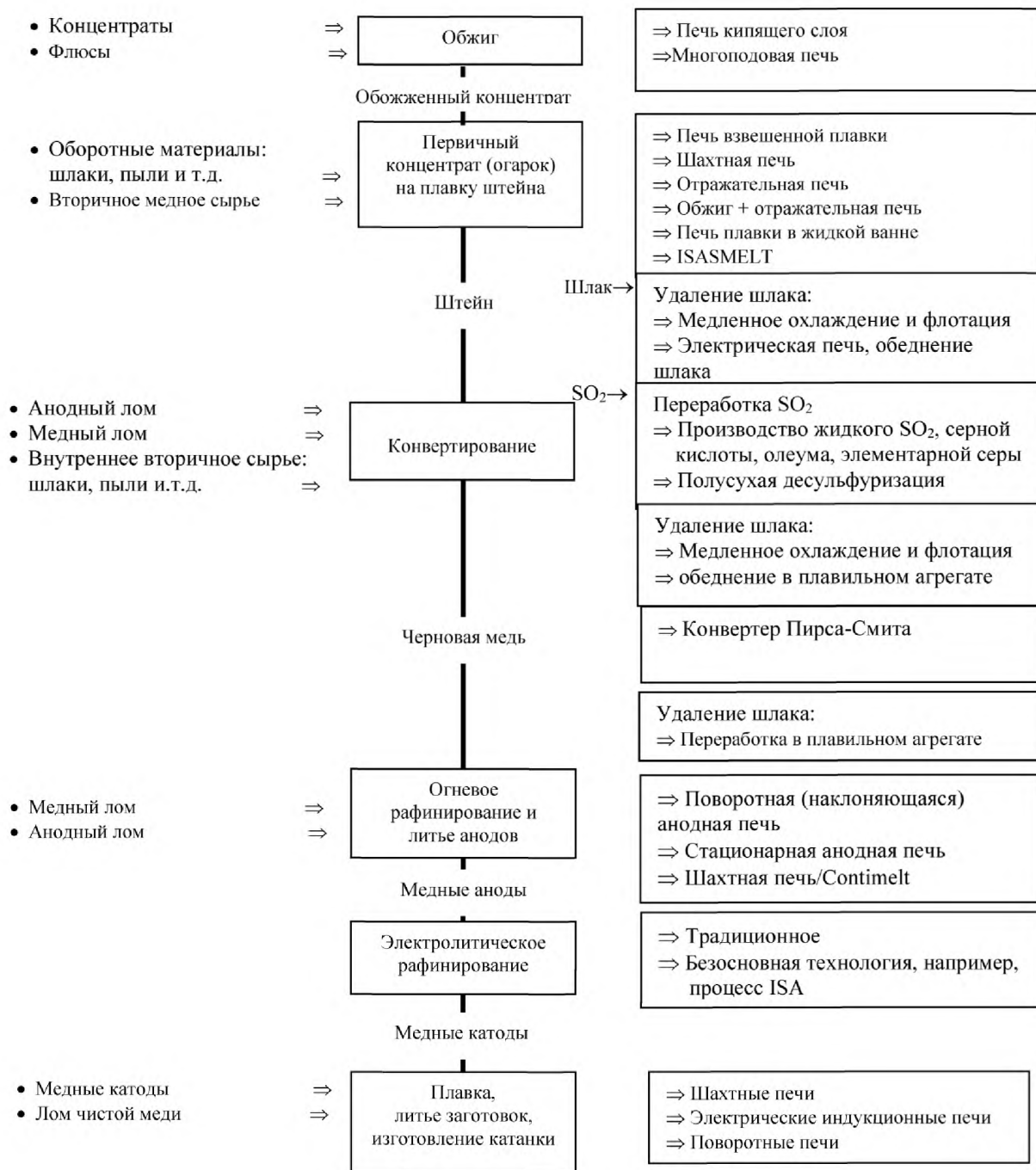
Рисунок 2.1 — Схема процесса производства первичной меди
