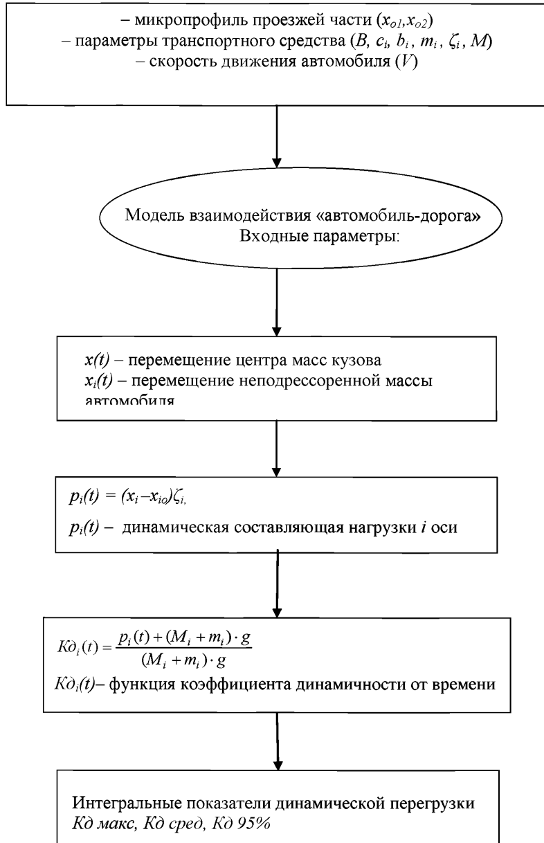
Рисунок 6.3 Расчет коэффициента динамичности на участке автомобильной дороги
