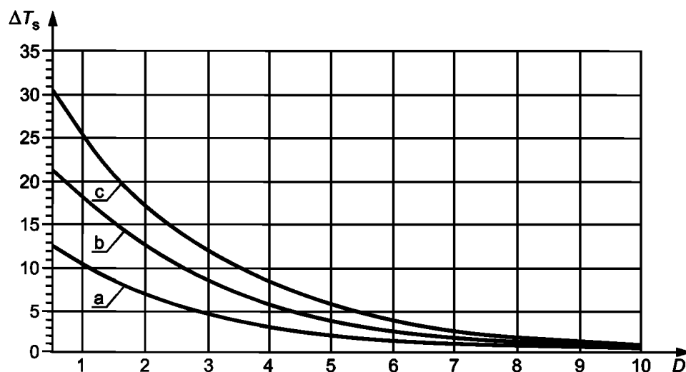
Рисунок 3 — Повышение температуры поверхности в области разброса порога возникновения ожога, приведенного на рисунке 2 для металлов, покрытых лаком толщиной в 50, 100 и 150 мкм
