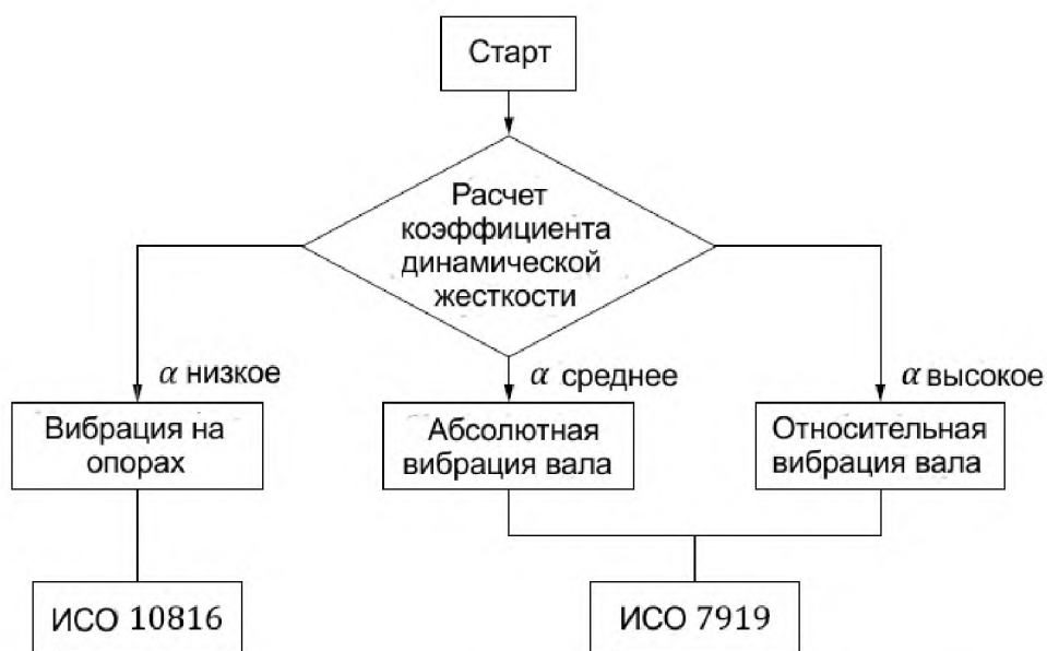
Рисунок 2 — Блок-схема выбора стандарта для измерений вибрации
