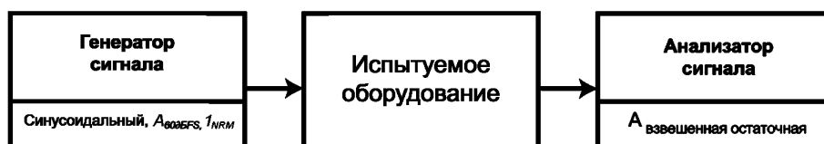
Рисунок 24 — Метод измерения динамического диапазона
