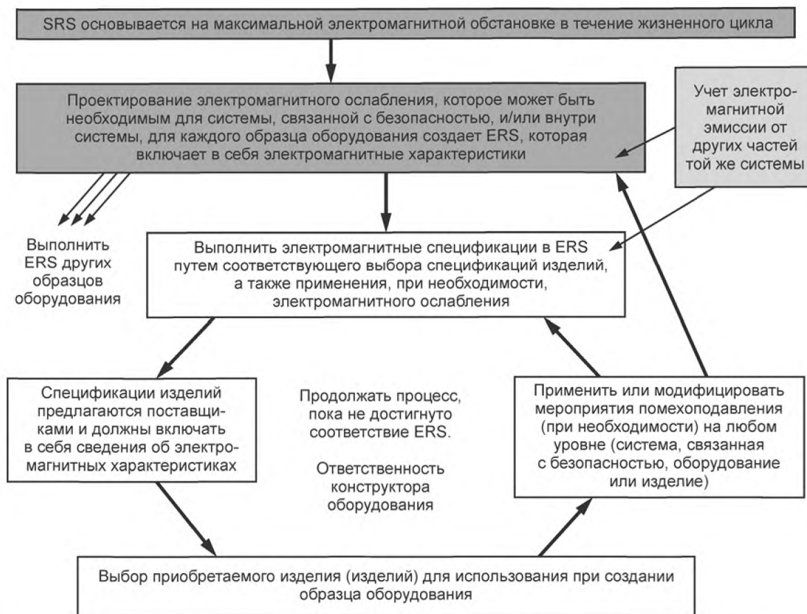
Рисунок D.2 — Процесс достижения электромагнитной спецификации в SRS при использовании коммерчески доступных изделий
