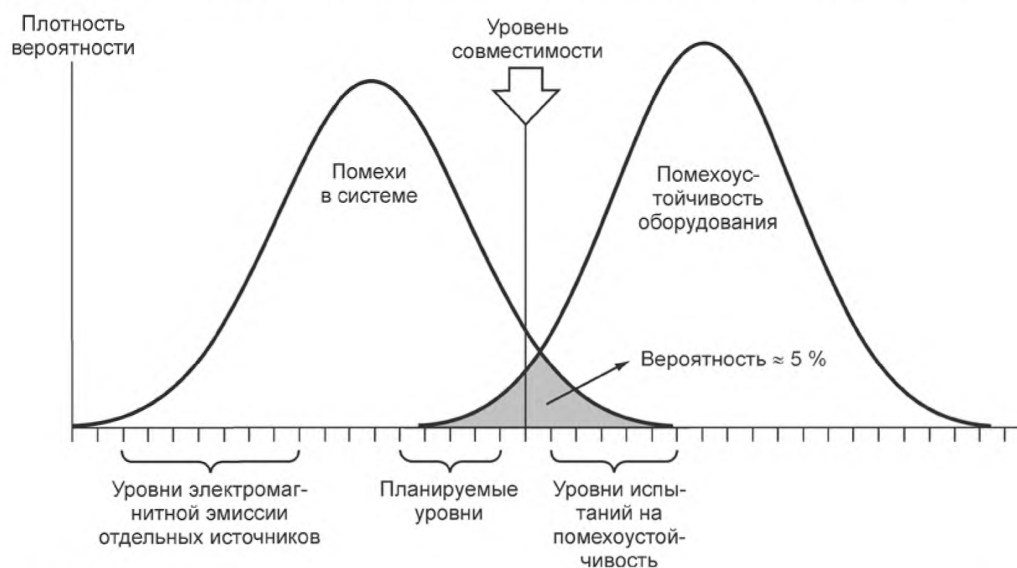
Рисунок E.1 — Уровни электромагнитной эмиссии/помехоустойчивости на примере уровней электромагнитной эмиссии/помехоустойчивости для одного эмиттера и одного рецептора в зависимости от некоторых независимых переменных (например, амплитуд импульсов в пачке или уровней напряженности поля)
