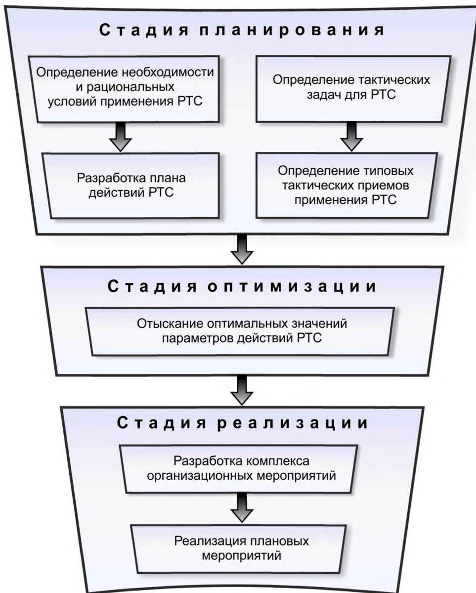
Рисунок 3 Стадии планирования применения робототехнических средств пожаротушения
