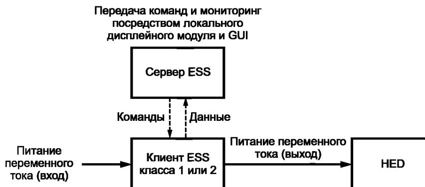
б) Измерение потребляемой энергии с использованием сервера ESS и клиента ESS
