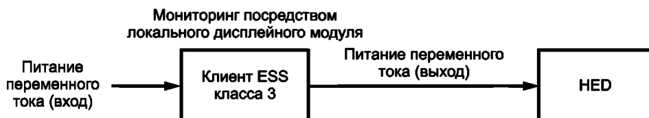
а) Измерение потребляемой энергии с использованием одного клиента ESS класса 3
