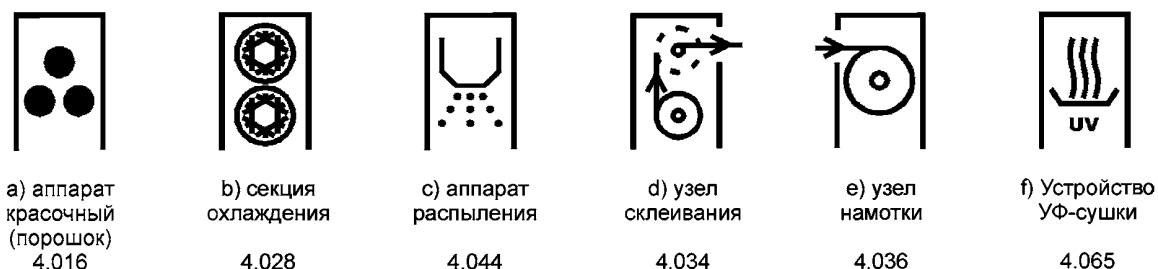
Рисунок А.7 — Примеры комбинирования базовых символов для обозначения секций и модулей, являющихся составной частью оборудования
