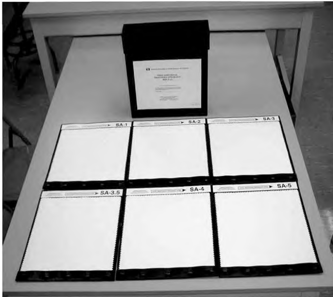
Рисунок 2 — Трехмерные эталоны гладкости
