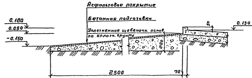
Деталь отмостки по буквенным осям.
