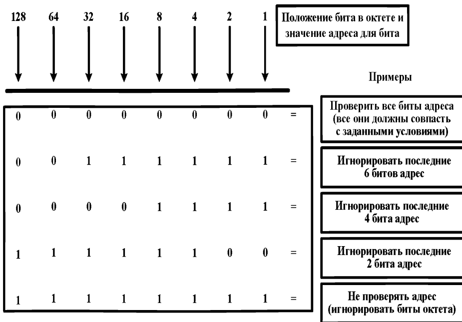
Рис. А.7. Тщательный подбор шаблона маски позволяет выбрать один или несколько IP-адресов для выполнения тестов на разрешение доступа или отказ в доступе
