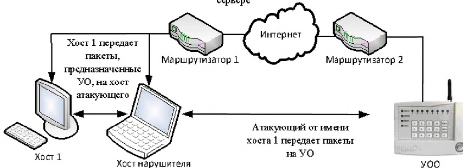
Рисунок 3.5. Схема реализации угрозы «Навязывание ложного маршрута» (межсегментное) с целью перехвата трафика
