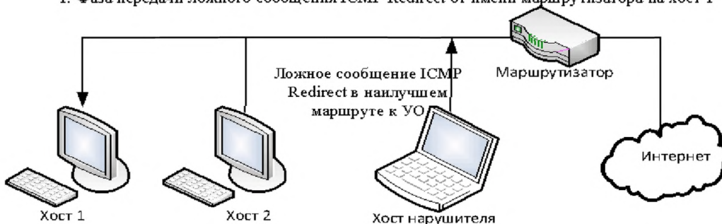
Рисунок 3.4. Схема реализации атаки «Навязывание ложного маршрута» (внутрисегментное) с использованием протокола ICMP с целью нарушения связи
