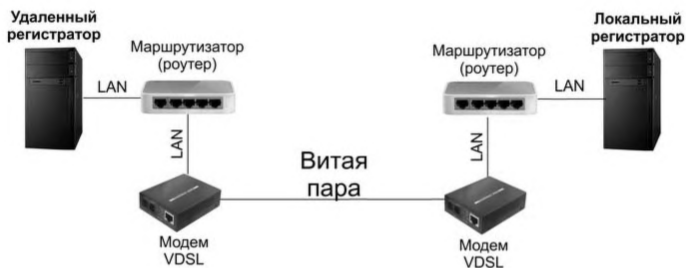
Рис. 4 - Структурная схема работы локального видеорегистратора с удаленным видеорегистратором по локальной сети с использованием xDSL-модемов
