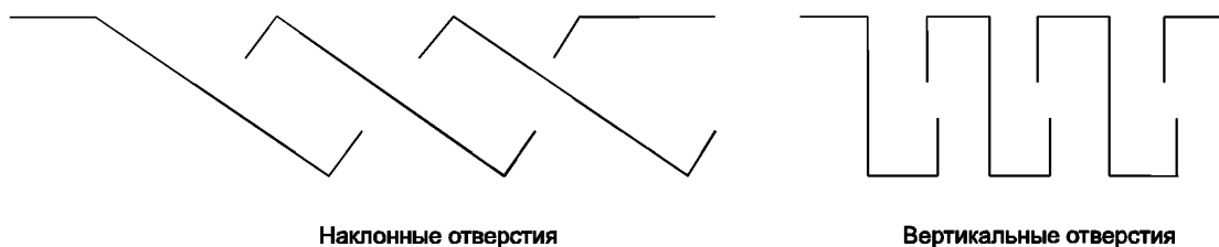
Рисунок 4В — Примеры поперечного сечения конструкции отверстий
