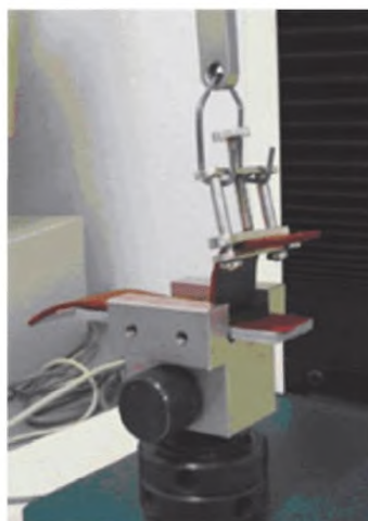
Рисунок 5 — Расположение испытуемого образца и зажимов для испытаний в варианте с плоскими тисками
