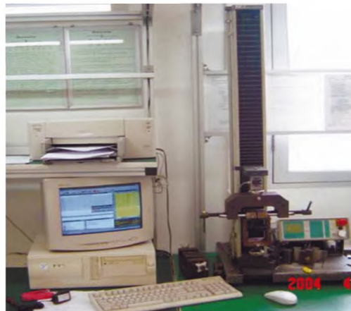
Рисунок D.2 — Машина для определения усилия разъединения частей корпуса
