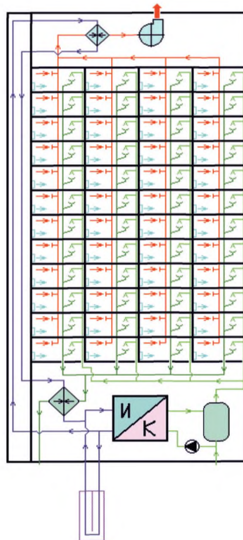
Рисунок 9 – Комбинированное использование теплоты вентиляционных выбросов, грунта и канализационных стоков жилого дома
