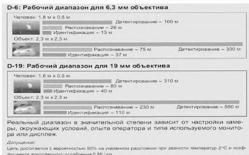
Рис. 129 Рабочий диапазон объективов камер серии D
