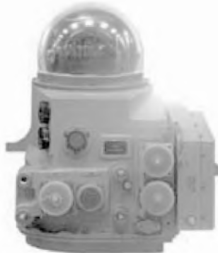
Рис. 62 Оптико-локационная станция 13СМ-1
