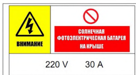
Рисунок Г.3 — Примеры знака, информирующего об опасности возникновения пожара на главном распределительном щите здания (см. 10.5.1)
